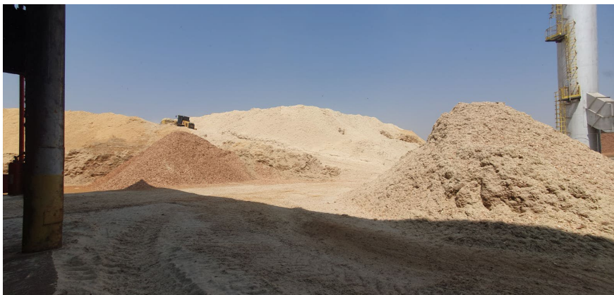
Foto 4: Estoque de bagaço (fundo), cavaco (esquerda) e mistura de cavaco e bagaço (direita) da Usina Lasa Lago Azul.
